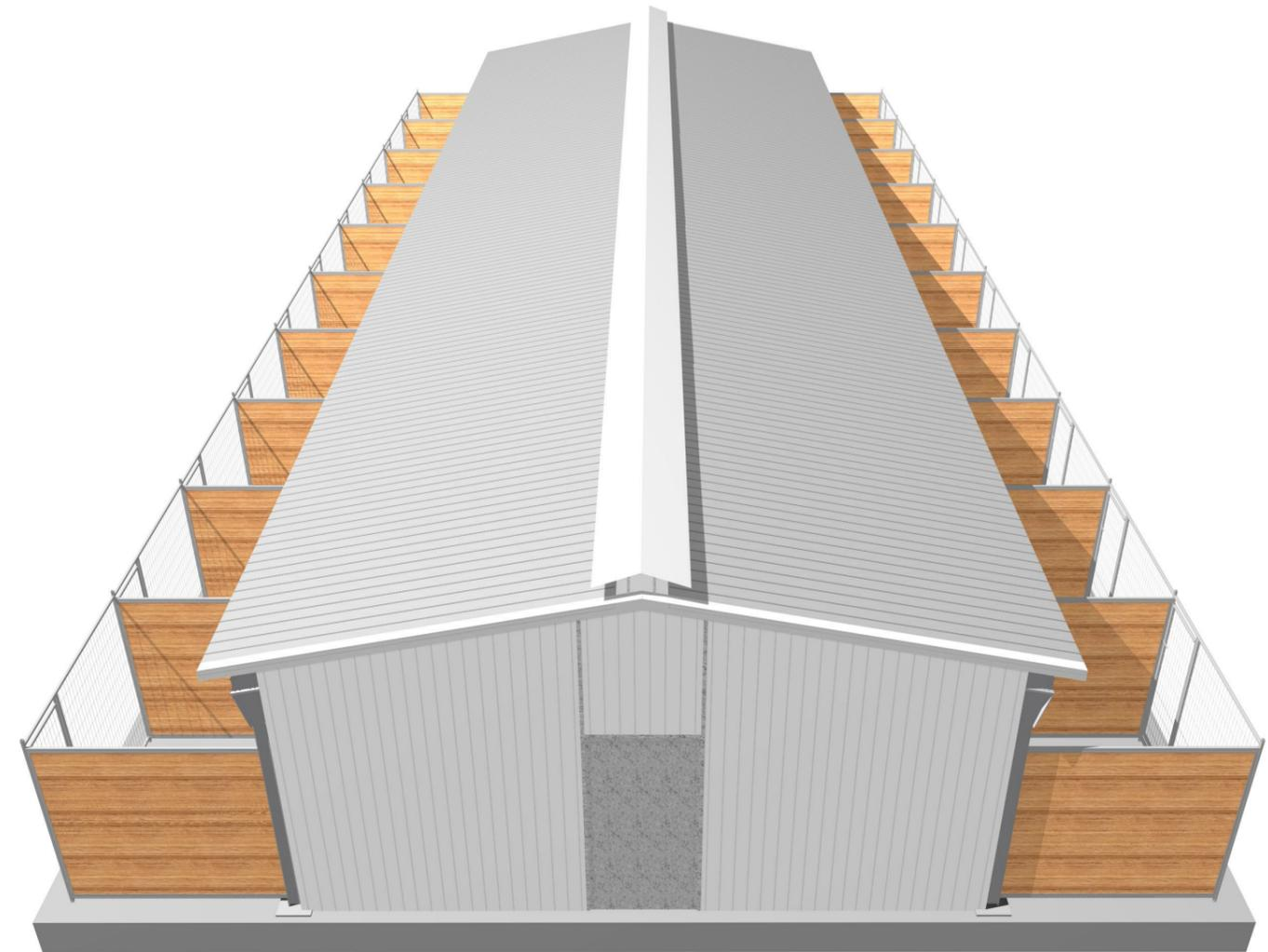
**Cubierta de panel sándwich** (chapa-poliuretano-chapa) de 30 mm. de espesor, **con** **cumbrera móvil** para facilitar la **ventilación interior**.
